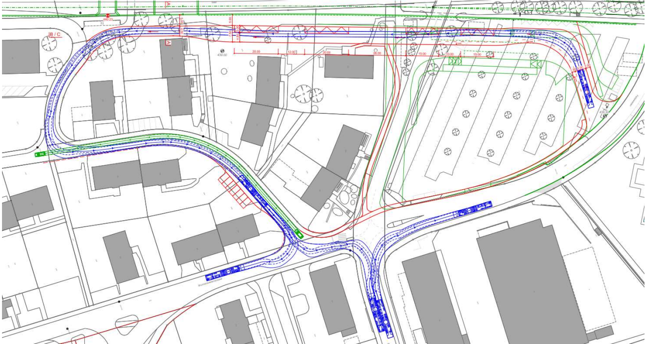
Abbildung 14 Auszug Situation mit Schleppkurven (Blau Gelenkbus, Grün Personenwagen)
