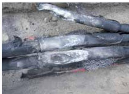
Defekte Kabelmuffe 16-kV
